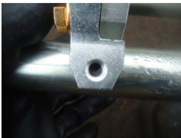
Figura 4 - Peça com a furação deslocada
