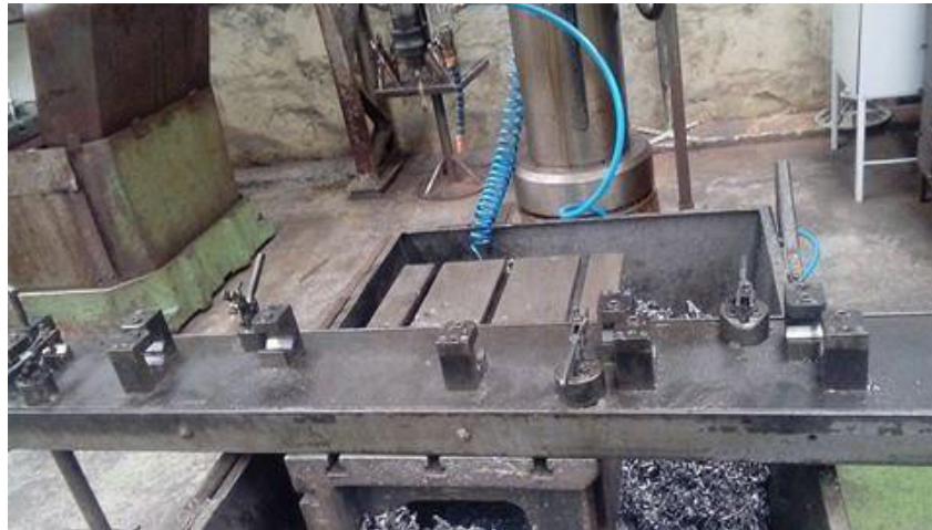
Figura 6 - Dispositivo para furação e produção da peça (A-TUBO)
