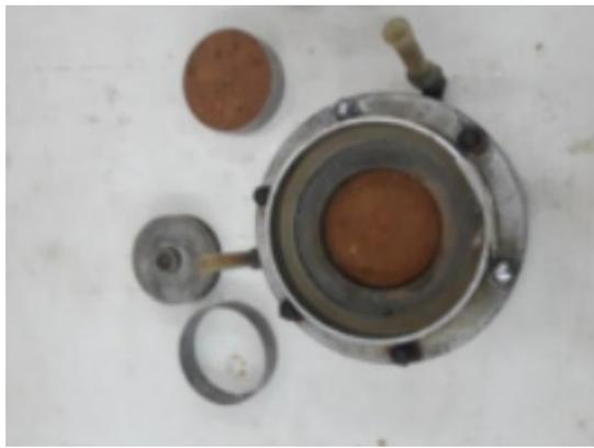
Figura 2. Amostra do solo – Estado saturado (fonte autor)
