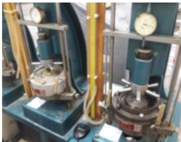
Figura 1. Ensaio de adensamento em andamento (fonte autor)
