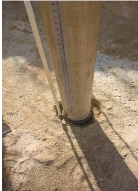
Figura 3. Régua graduada para auxiliar na realização das leituras.
