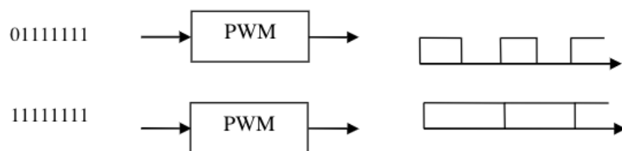
Figura 3 – Característica de funcionamento do PWM
