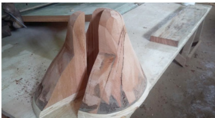
Figura 1. Tocos de madeira após serem colados com cola branca e pó de serra e serem lixados em forma de vulcão.
