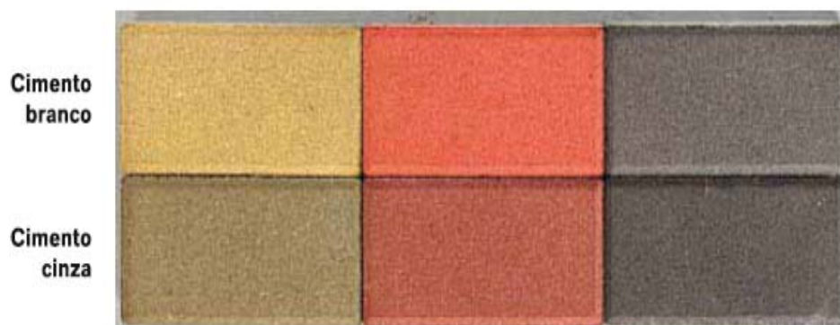
Figura 5 - A Influência da cor do Cimento na Tonalidade Final.
