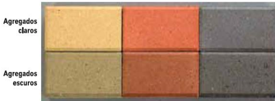
Figura 6 - A Influência da Cor do Agregado na Tonalidade Final. Fonte: Know_How_Final_Ptlow_02.Pdf.
