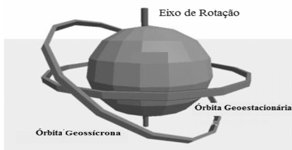
**Figura 3.** Diferença entre órbita geossíncrona e geoestacionária.
