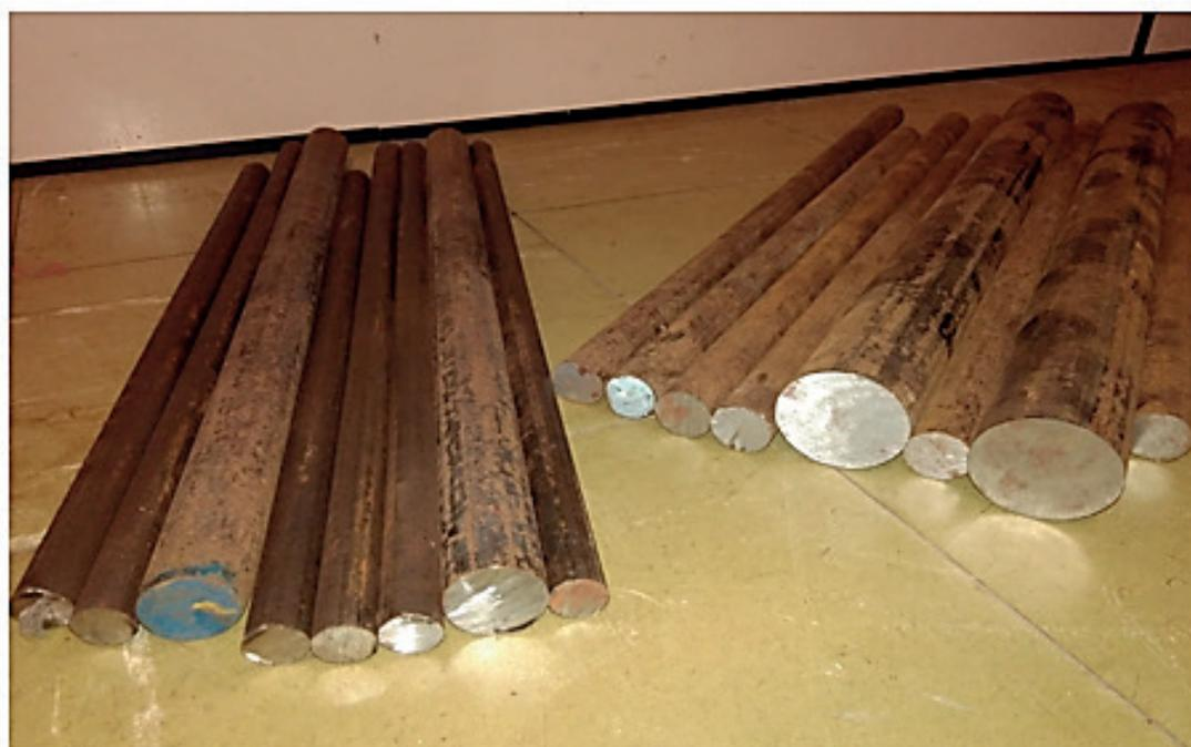
Figura 2: Barras cilíndricas de aço 1020 e 1045.
