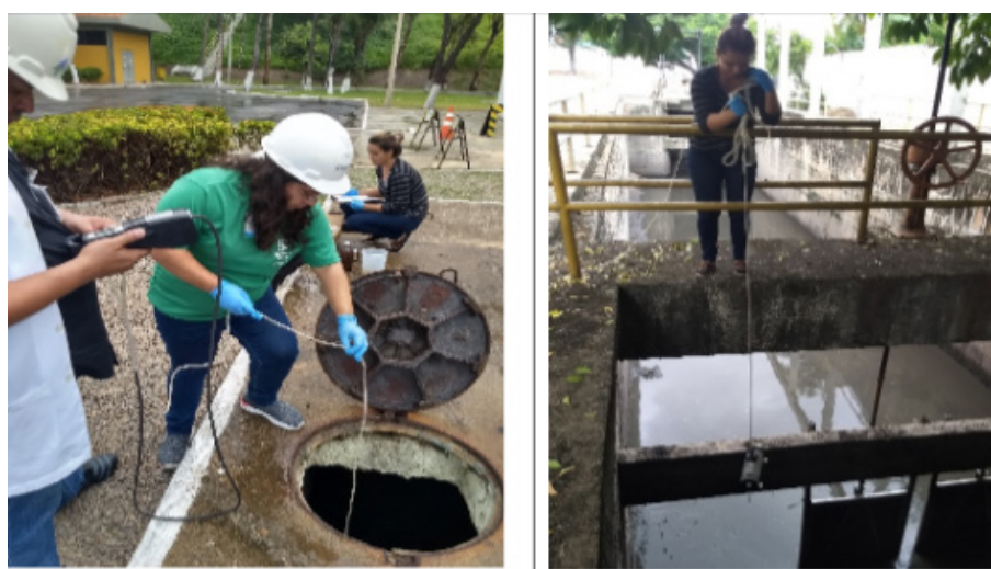
Figuras 3 e 4: Coleta de amostras na EPC e Estações Elevatórias de Esgoto. Data: 22/03/18;
