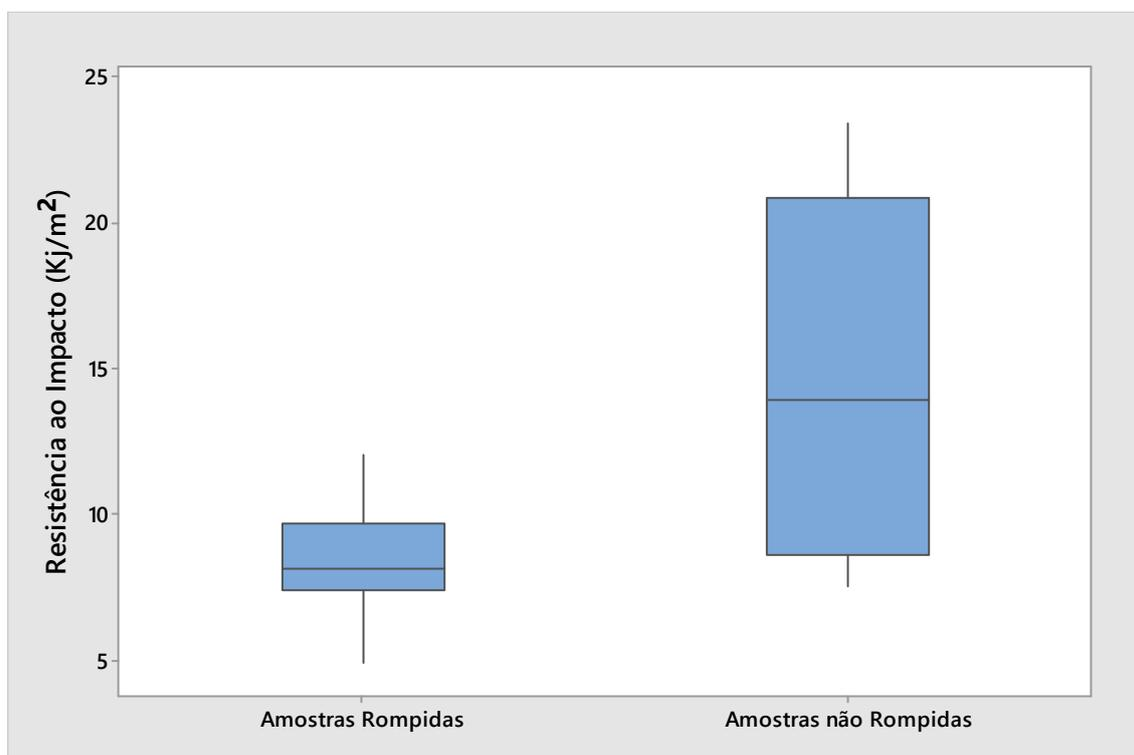
FIGURA 8: Boxplot para resistência ao impacto entre amostras quebradas e intactas.
