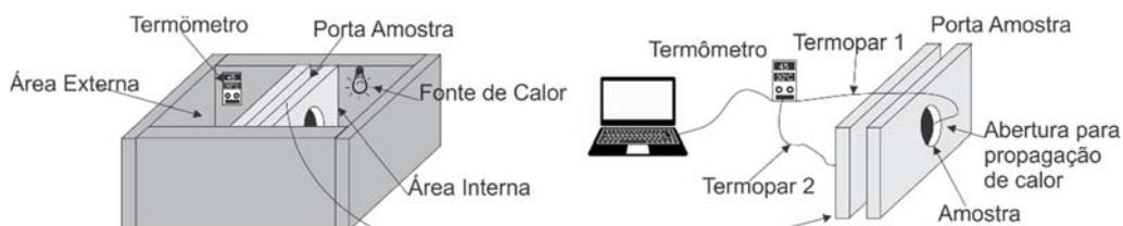
FIGURA 2: Sistema utilizado para medir a condutividade térmica das amostras.
