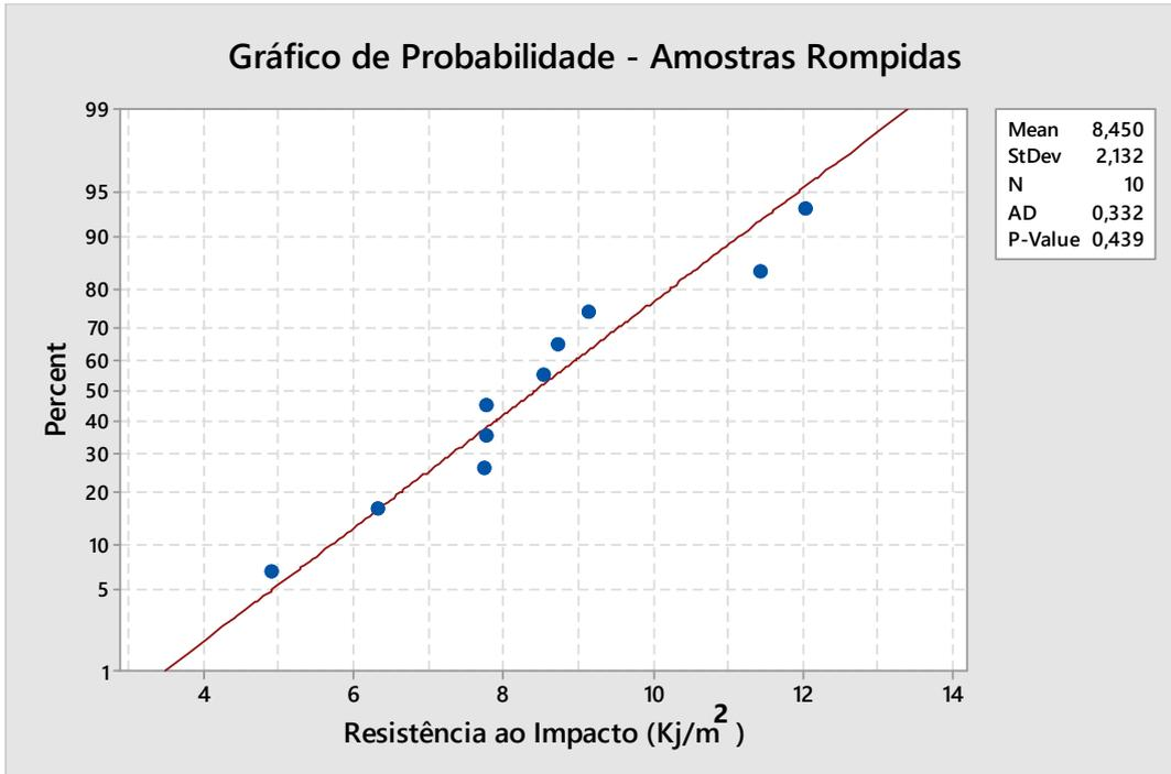
FIGURA 4: Teste de normalidade para o compósito de fibra de coco para amostras quebradas.
