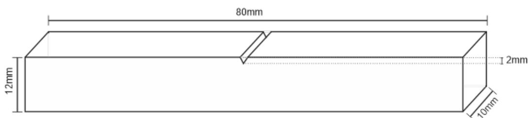
FIGURA 3: Dimensões do feixe simples, tipo Charpy, amostra de teste de impacto.
