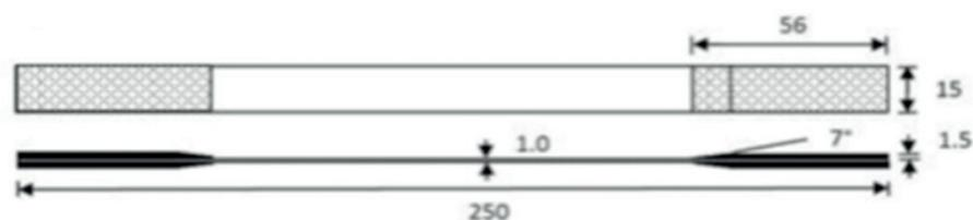
Figura 2. Dimensões do corpo de prova segundo a norma ASTM D3039M.
