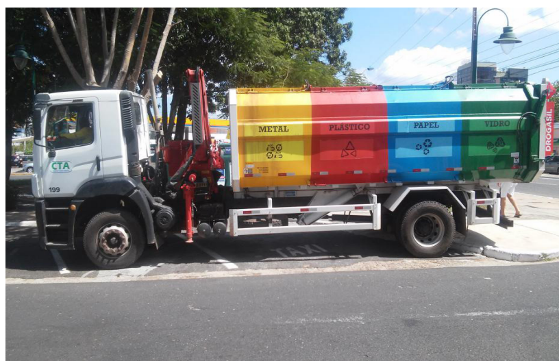
Figura 6: Carro adaptado para a coleta e transporte dos resíduos dispostos nos PEV.
