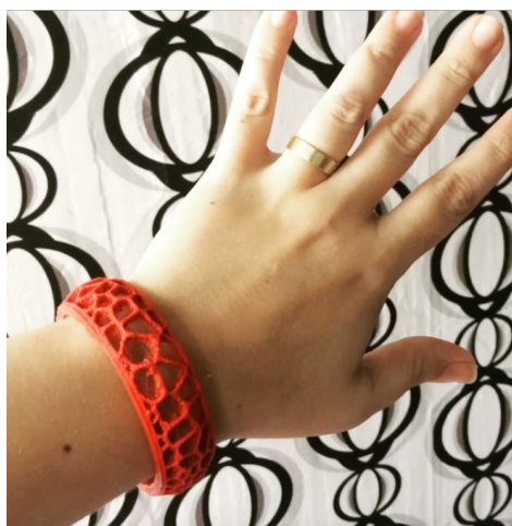
Figura 5: Pulseira impressa por Manufatura Aditiva, em Fab Lab, a partir de modelo 3D open source encontrado na Web.
