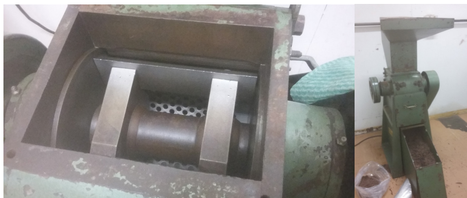
Figura 3 – Moinho utilizado para moagem das aparas de couro acabado
