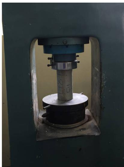
Figura 5: Ensaio de resistência à compressão.
