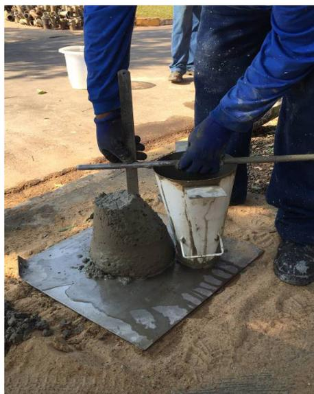
Figura 5: Ensaio de abatimento do tronco de cone.
