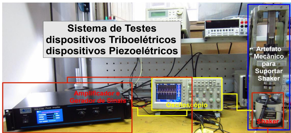
Figura 1 Sistema de Testes
