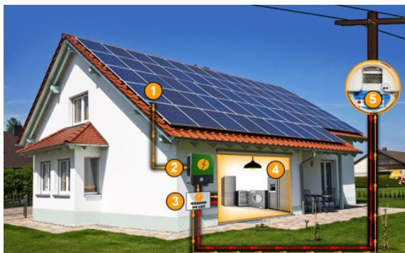
Figura 2: Sistema FV conectado à rede elétrica.
