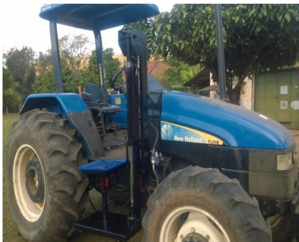
FIGURA 2. Trator de teste após ser instrumentado.
