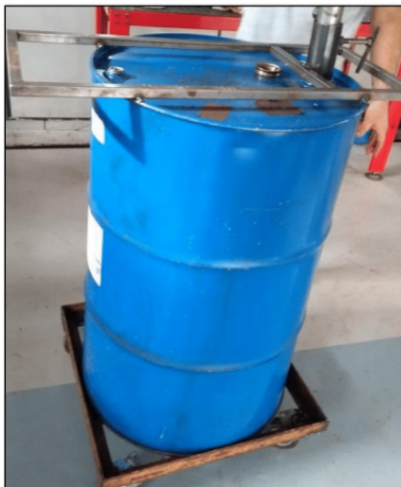
Figura 03 – Tanque de armazenamento do óleo usado ou contaminado em Oficina Mecânica no município de Quinze de Novembro/RS
