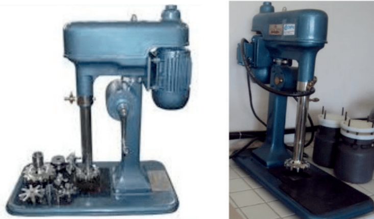
Figura 03 – Máquina de Flotação de Laboratório MacDarma modelo D-12, para os Testes de Flotação do Rejeito de Minério Aurífero.
