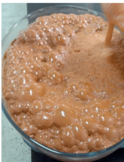
Figura 04 – Espumas geradas na flotação do concentrado blend do rejeito aurífero.
