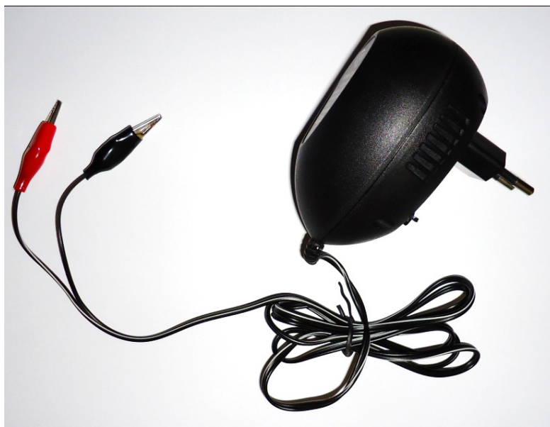
Figura 1. Fonte de energia escalonada de até 12V do sistema. Autoria própria.
