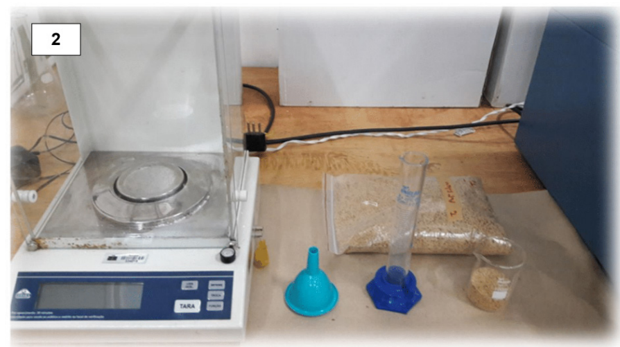
Figura 2. Balança analítica, proveta graduada de 50ml e funil, usados para determinar a massa específica aparente.
