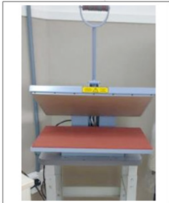
Figura 3: Representação da prensa térmica utilizada na preparação da técnica de estamparia denominada sublimação botânica.
