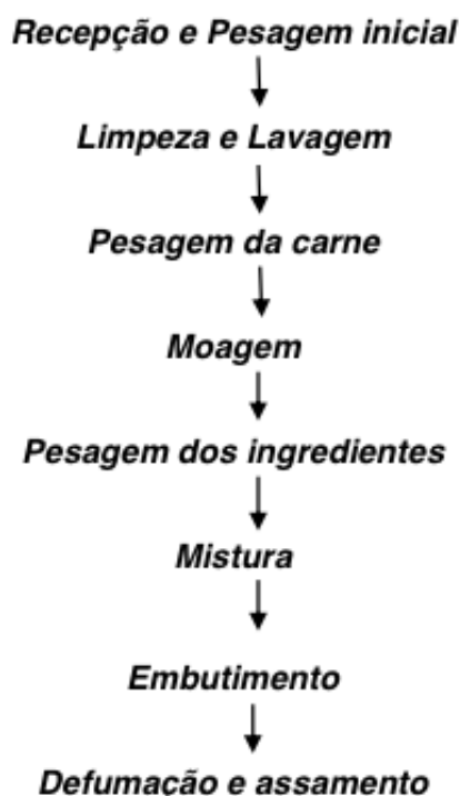
Figura 1 - Fluxograma das etapas de processamento da linguiça fresca e defumada de Carpa Capim ( Ctenopharyngodon idella )
