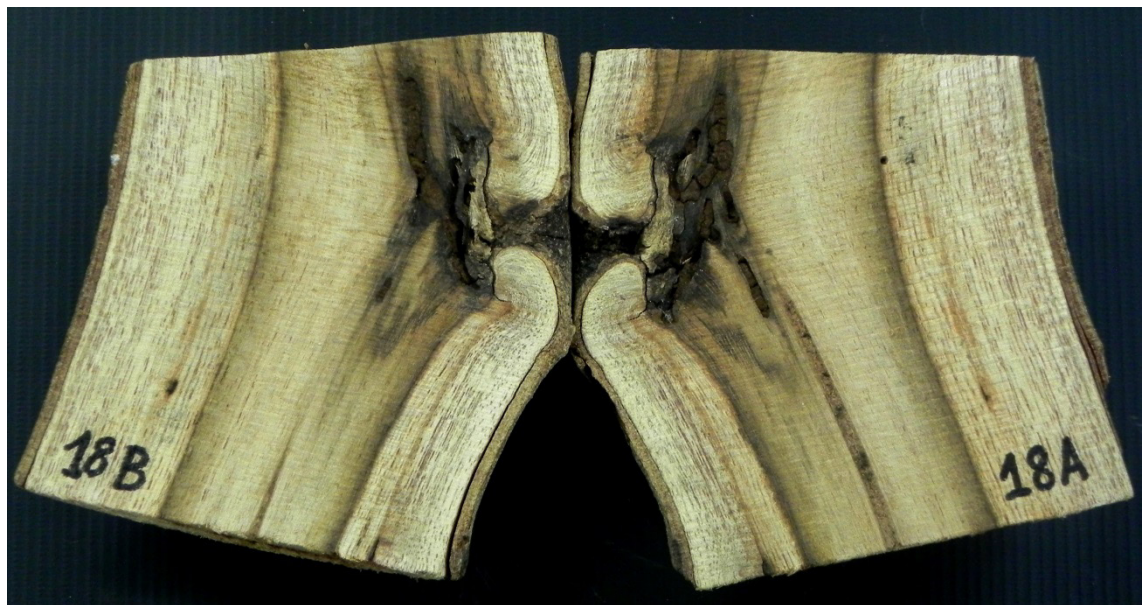
Figura 5 – Peça nº 18 (aleluia) seccionada longitudinalmente para expor necrose interna omitida pela oclusão parcial.
