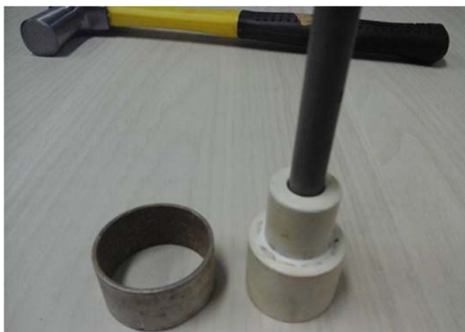
Figura 2. Equipamento para realizar a compactação estática das amostras
