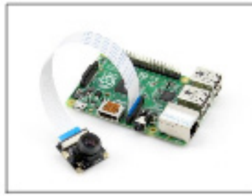
Figura 1. Raspberry Pi modelo B+ com o módulo de câmera.
