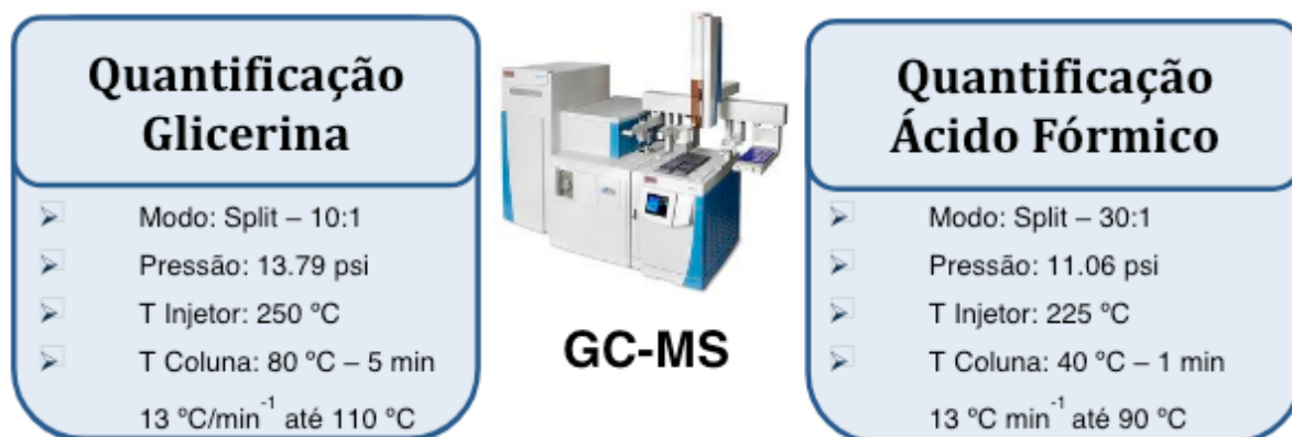
Figura 7 – Parâmetros utilizados no equipamentos GC-MS para quantificação dos compostos glicerina e carbonato de glicerina
