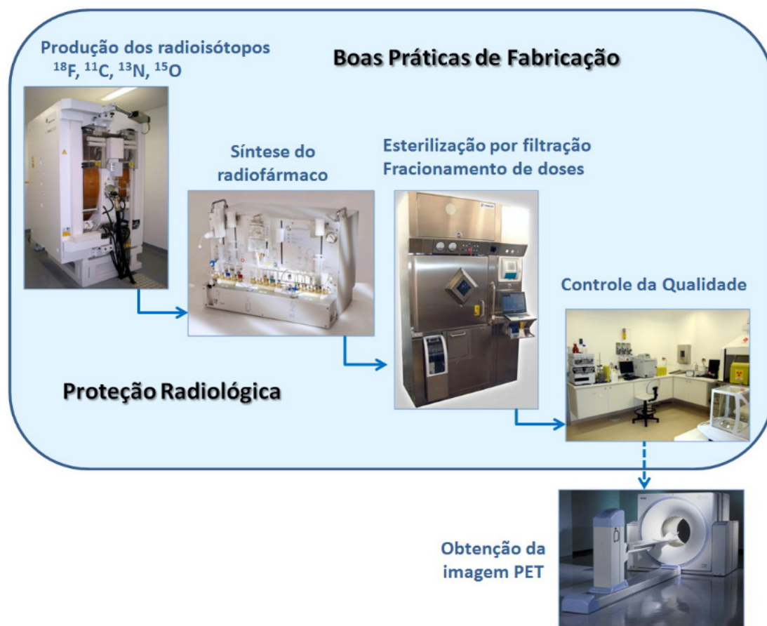
Figura 2. Abrangência da aplicação das Boas Práticas de Fabricação na área de radiofarmácia.
