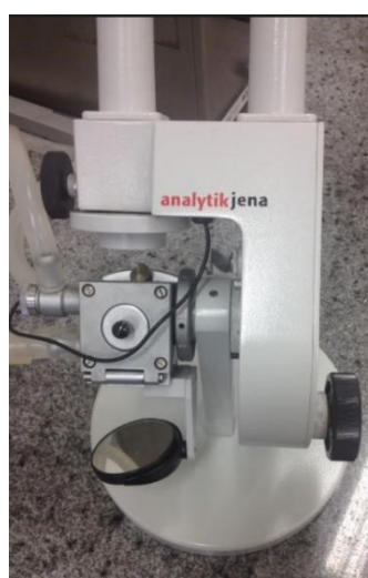
Figura 3. Refratômetro Analytik Jena utilizado para obtenção dos índices de refração
