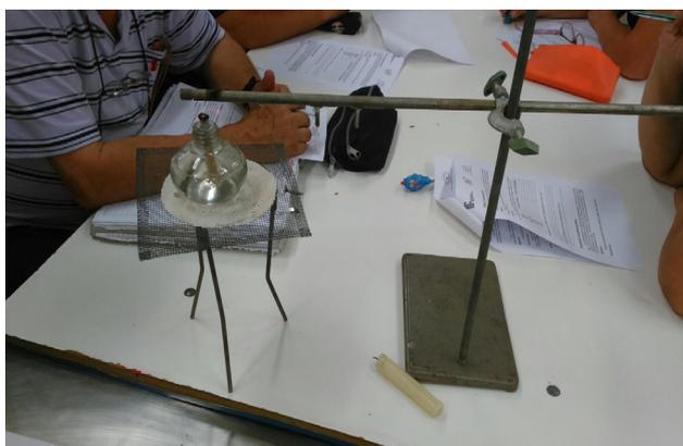
**Ilustração 3** - Esquema de aparelhagem para o experimento da condutividade térmica.
