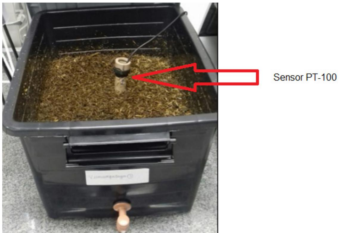
Figura 11 – Instalação do sensor PT-100 no centro do vermirreator
