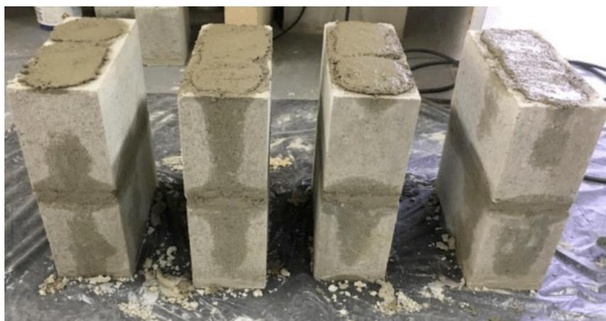
Figura 11 - Absorção da água do graute pelo prisma
