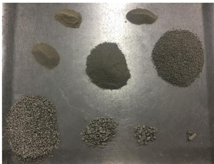
Figura 2 - Amostras do resíduo utilizado na substituição do agregado natural
