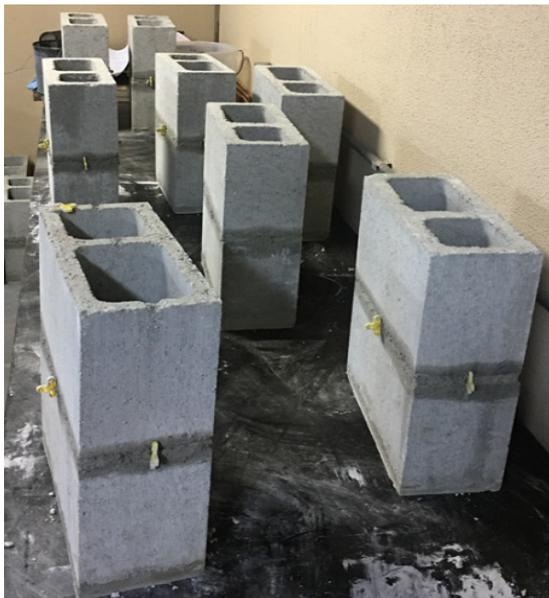
Figura 3 - Montagem dos prismas
