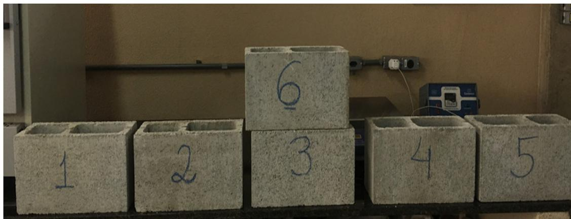
Figura 1 – Blocos de concreto estruturais utilizados na pesquisa
