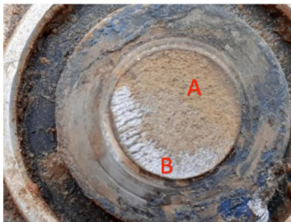
Figura 1 – região onde ocorreu a falha
