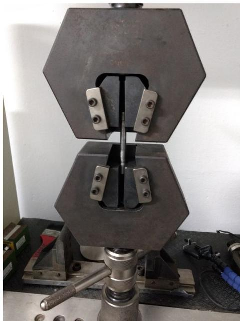
Figura 4 – Realização do ensaio de tração
