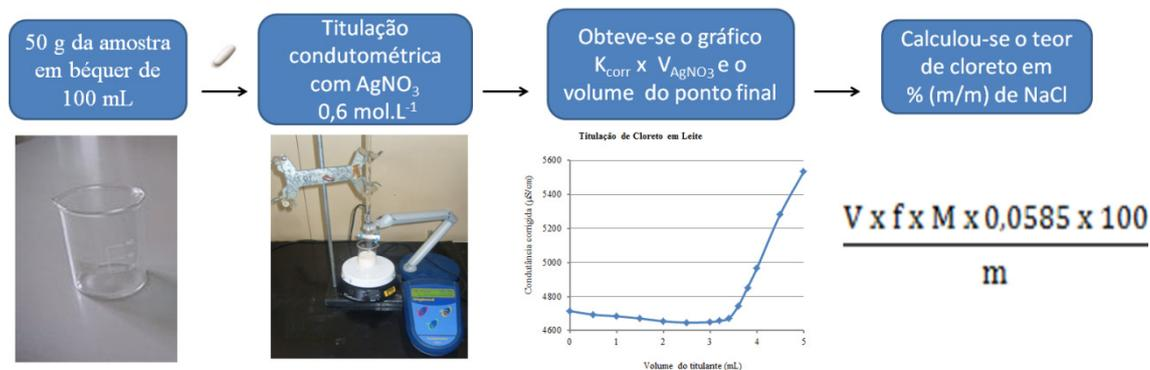
Figura 5. Esquema do método condutimétrico para determinação de cloretos em Leite.
