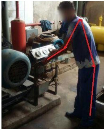
Figura 6 – Verificação do quadro de temperatura, pressão e sucção do óleo
