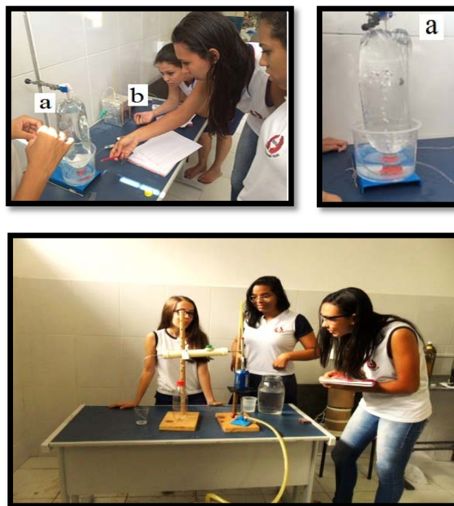
Figura 1: Na fotografia os alunos estão monitorando a temperatura do processo de fermentação, utilizando um equipamento montado com materiais alternativos, acoplado a um destilador produzido com tubos de PVC
