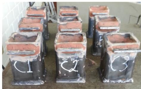
Figura 2. Caixas para a cementação
