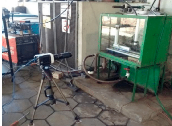
Figura 2. Montagem do sistema de soldagem
