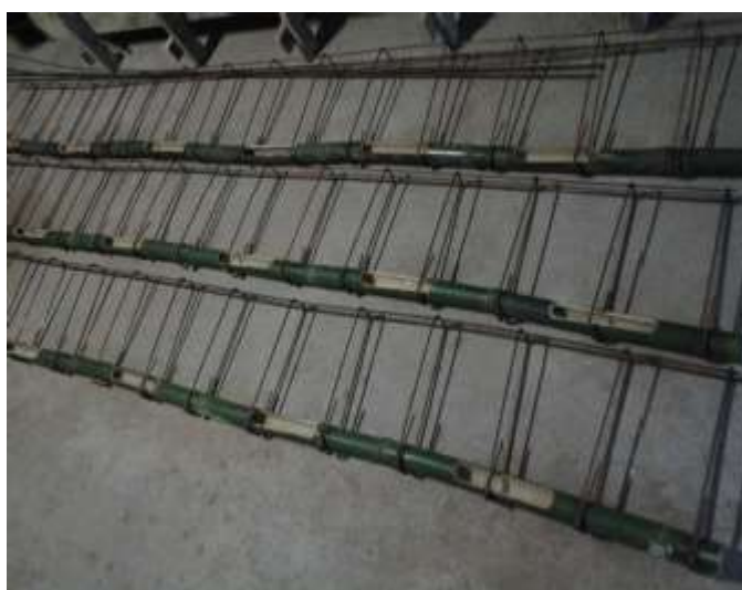
Figura 10 - Abertura no colmos de bambu para incremento de aderência (ensaio 5) – Fonte: (OLIVEIRA, 2012).
