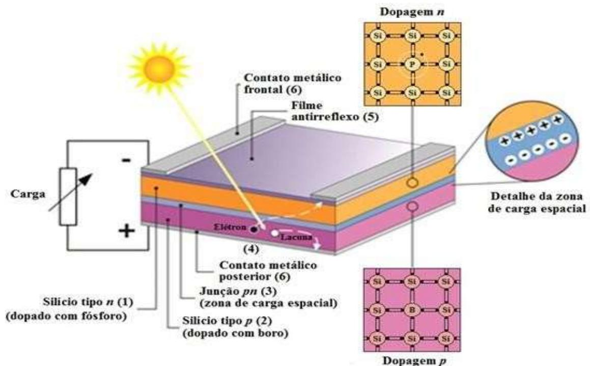
Figura 5: Célula Fotovoltaica. Fonte: Adaptada de Moehlecke e Zanescos,( 2005, p 112
