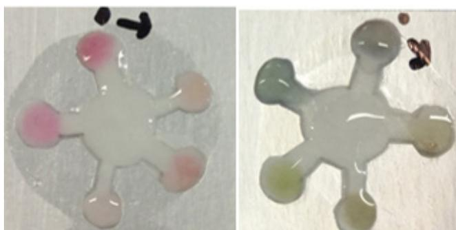
**Figura 8.** Teste de estabilidade dos dispositivos de papel em formato de flor contendo os indicadores de repolho roxo, cebola roxa, rosa vermelha, begônia vermelha e begônia alaranjada em solução aquosa de pH 2 e pH 12, respectivamente, realizado após duas semanas (a contar da data da sua construção).
