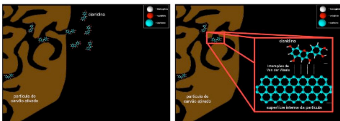
Figura 3: A molécula de corante, as reentrâncias da partícula de carvão (esq.) e a adsorção (dir.)
