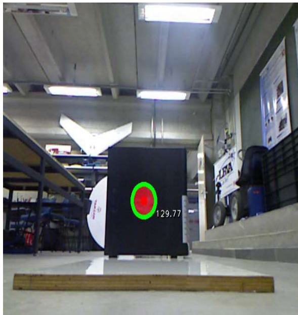
Figura 6: Visão do sensor e determinação da distância do objeto em cm. Fonte: Autor 2017.
