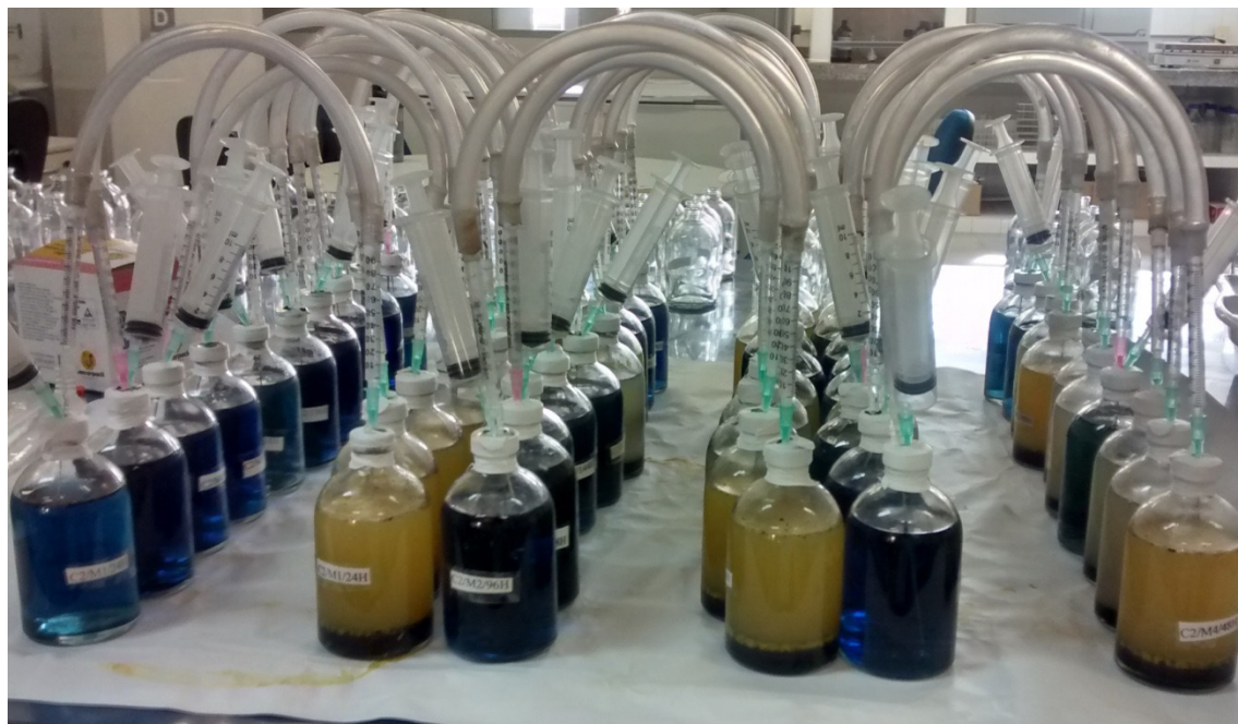
Figura 3 – Frascos reatores com 20 % de headspace/ Autora.
