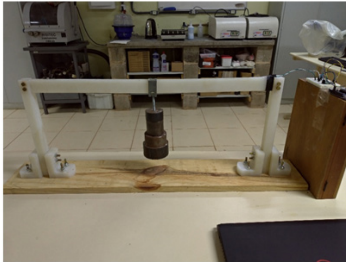
Figura 5 - Carregamentos a 300 mm do extensômetro
