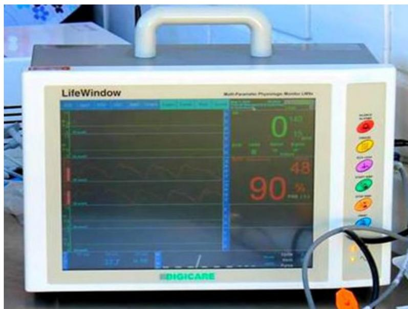
**Figura 3.** Monitor multiparamétrico Life Window – Digicare para aferição de FC e PAS.
