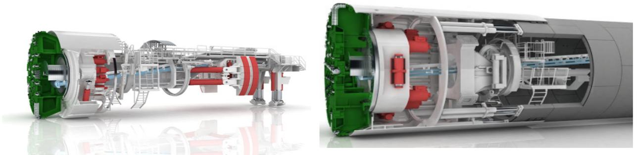
Figura 10 - TBM Gripper que utiliza sapatas para a transmissão dos esforços ao maciço (à esquerda) e TBM Shield que transmite os esforços através do atrito entre o revestimento primário e o maciço (à direita)
