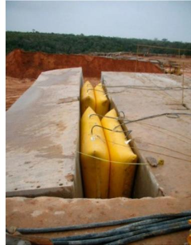
Figura 42- Tombador de blocos (esquerda) e colchão hidráulico sendo utilizado em lavra de mármore (direita)
