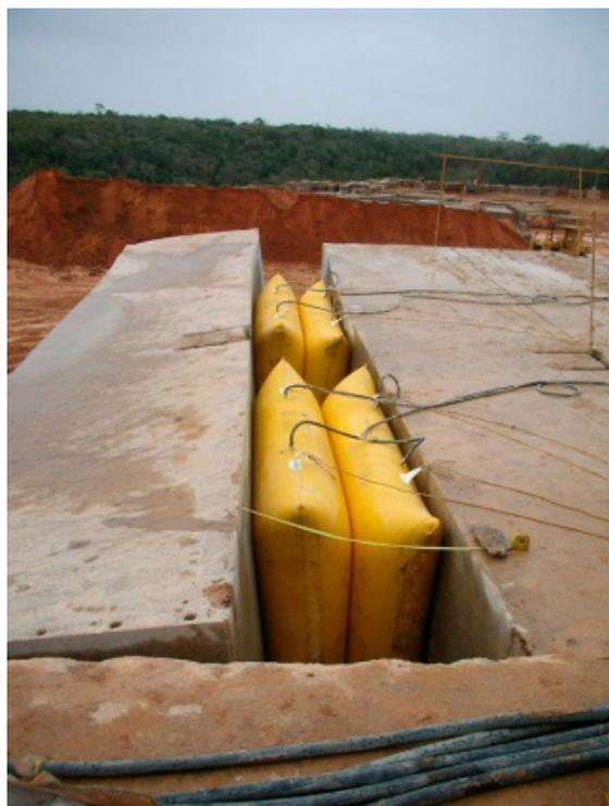
Figura 38 - Sistemas que utilizam sapatas hidráulicas (esquerda) e colchões hidráulicos (direita)
