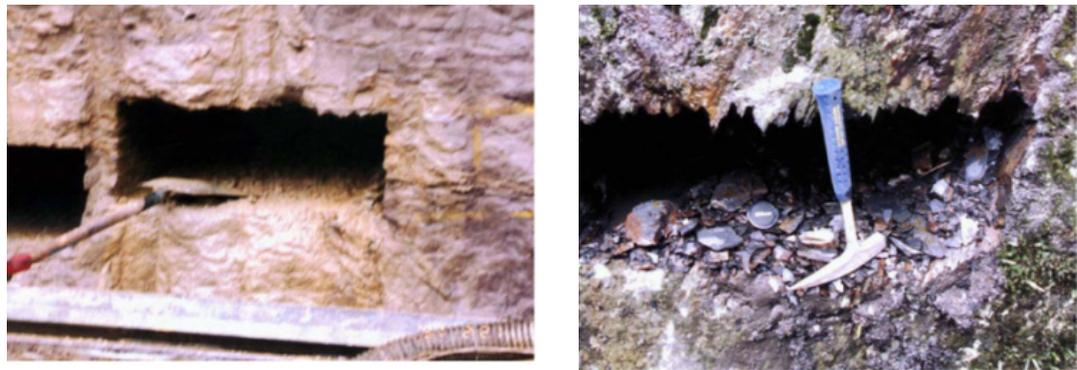
Figura 21 - Cavidades abertas por hidrodemolição em arenito (esquerda) e ardósia (direita)
