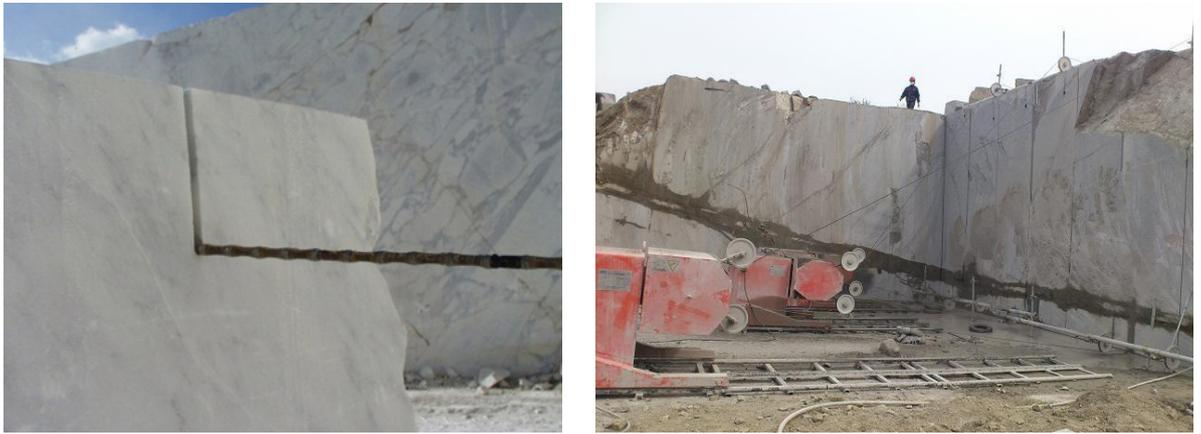
Figura 27 - O corte ocorre devido a translação do fio sobre a superfície da rocha (à esquerda) e o afastamento da unidade motriz da superfície de corte mantém a tensão no fio (à direita).
