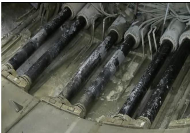
Figura 39 – Cilindros hidráulicos utilizados para movimentar TBM.
