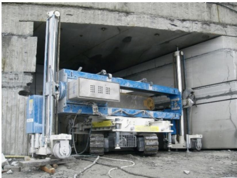
Figura 41 - Sistema real que utiliza o conjunto fuso, guia e acionamento por motor elétrico
