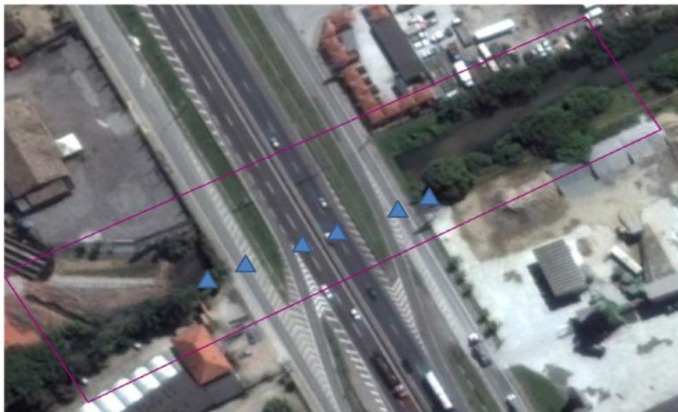
Figura 47 - Sistema de monitoramento de deslocamentos na rodovia.
