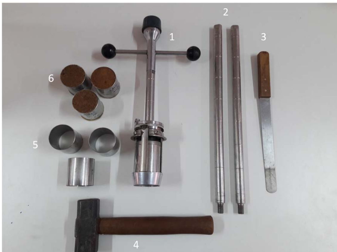
Figura 1 - (1) trado extrator tipo Uhland; (2) barras extensoras; (3) espátula; (4) marreta; (5) cilindros volumétricos sem e (6) com amostras.
